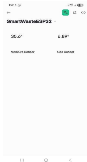
Gambar 8. Hasil Tampilan monitoring data sensor pada Blynk
