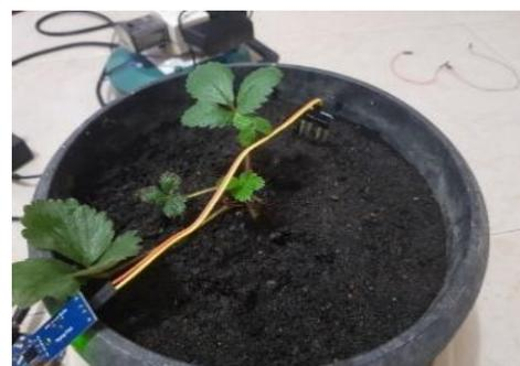
Gambar 16. Penempatan sensor kelembaban tanah
