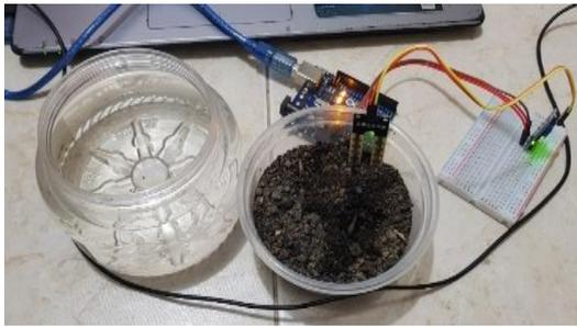
Gambar 11. Pengujian menggunakan sensor FC-28
