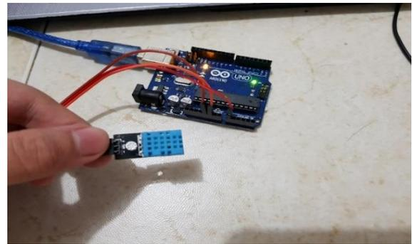
Gambar 14. Gambar 4.4 Sensor DHT11 dan Arduino Uno
