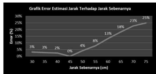
Gambar 23. Gambar 22 Grafik error estimasi jarak terhadap jarak sebenarnya
