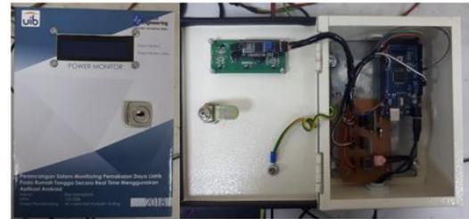
Gambar 4. Prototipe Monitoring Pemakaian Daya Listrik Rumah Tangga Berbasis *Android*
