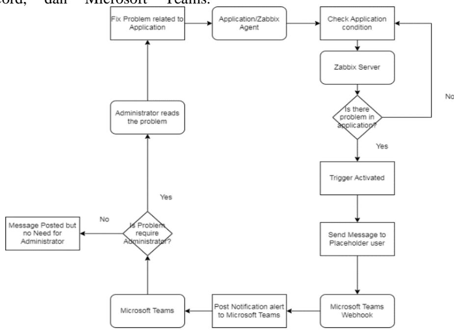
**Gambar 1.** menunjukkan flowchart alur kerja sistem Zabbix Monitoring yang menunjukkan metode kerja sistem dari penerimaan pesan dari perangkat keras hingga pengawasan dari administrasi.
