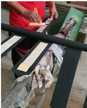
Gambar 10. Penempelan stiker pada papan bagian depan
