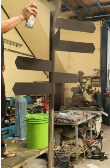
Gambar 9. Penyemprotan warna pada papan nama
