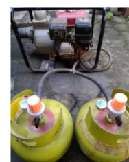
Genset elpiji (akhir)
