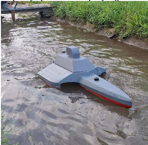
Gambar 3. Prototipe Kapal Trimaran dengan Sistem Propulsi Hibrida
