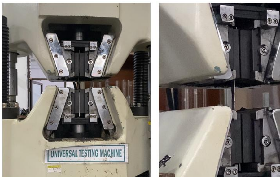
Gambar 3.3 Pengujian kupon tarik
