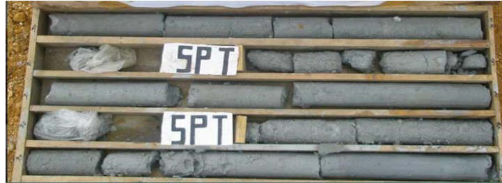
Gambar 4. 1 Sample Pengeboran Tanah
