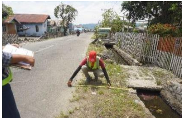
Gambar 3. Pengujian Komponen Geometrik Jalan. Sumber: BPJN XIV Palu, 2019
