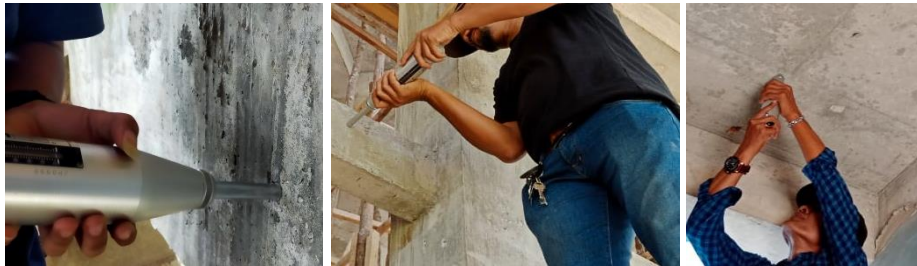
Gambar 2. Pengujian menggunakan alat Hammer Test pada komponen struktur (a) Kolom (b) balok dan (c) Pelat lantai
