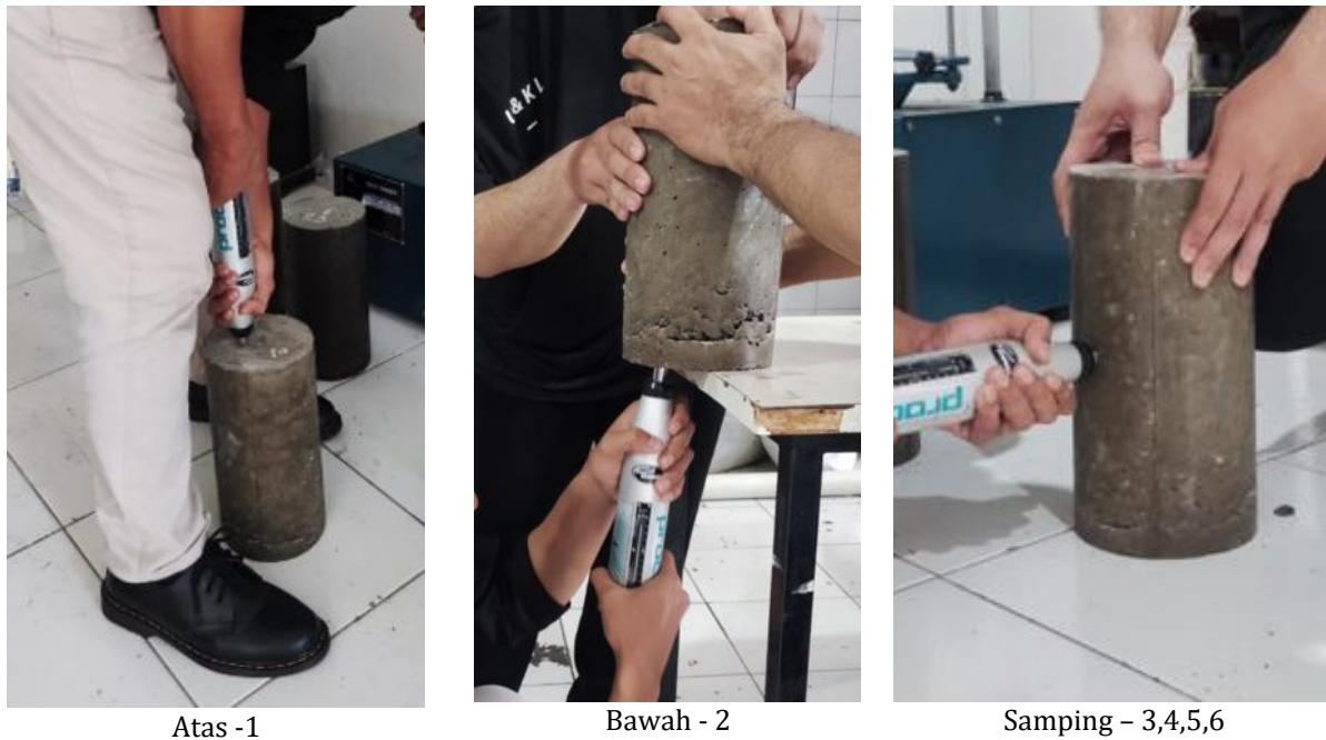
Gambar 3 Pengujian Hammer Test Pada Berbagai Posisi
