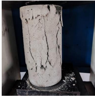
Gambar 9. Keretakan Beton Variasi GGBFS 40%
