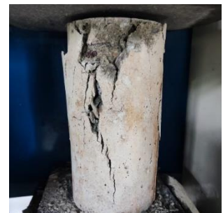
Gambar 7. Keretakan Beton Variasi GGBFS 30%
