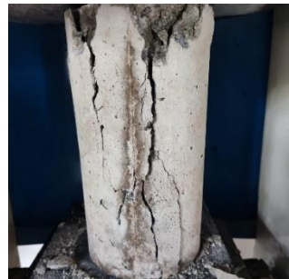
Gambar 6. Keretakan Beton Variasi GGBFS 25%
