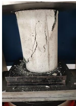
Gambar 10. Keretakan Beton Variasi GGBFS 45%
