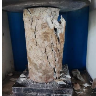
Gambar 5. Keretakan Beton Normal
