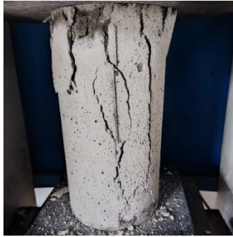
Gambar 8. Keretakan Beton Variasi GGBFS 35%
