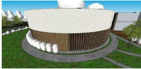
Gambar 14. Penggunaan Bukaan Sebagai Sumber Pencahayaan dan Ventilasi Alami Sumber: Dokumen Penulis, 2024
