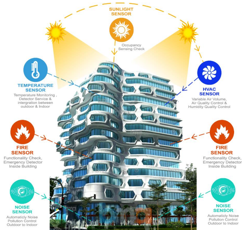
Gambar 1. Skema Cara Kerja Sistem Kontrol Sensor pada Facade Bangunan Gedung Sumber: Penulis (2024)
