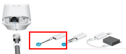
Gambar 3. Sambungan Kabel LAN ke Unifi AC Mesh
