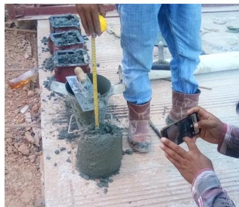
Gambar 4. Uji Slump
