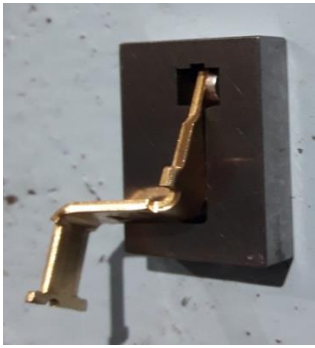
Gambar 11 (b). Jig untuk dimensi 90^\circ \pm 1^\circ contact fixed (Kasus: Not Good Parts)
